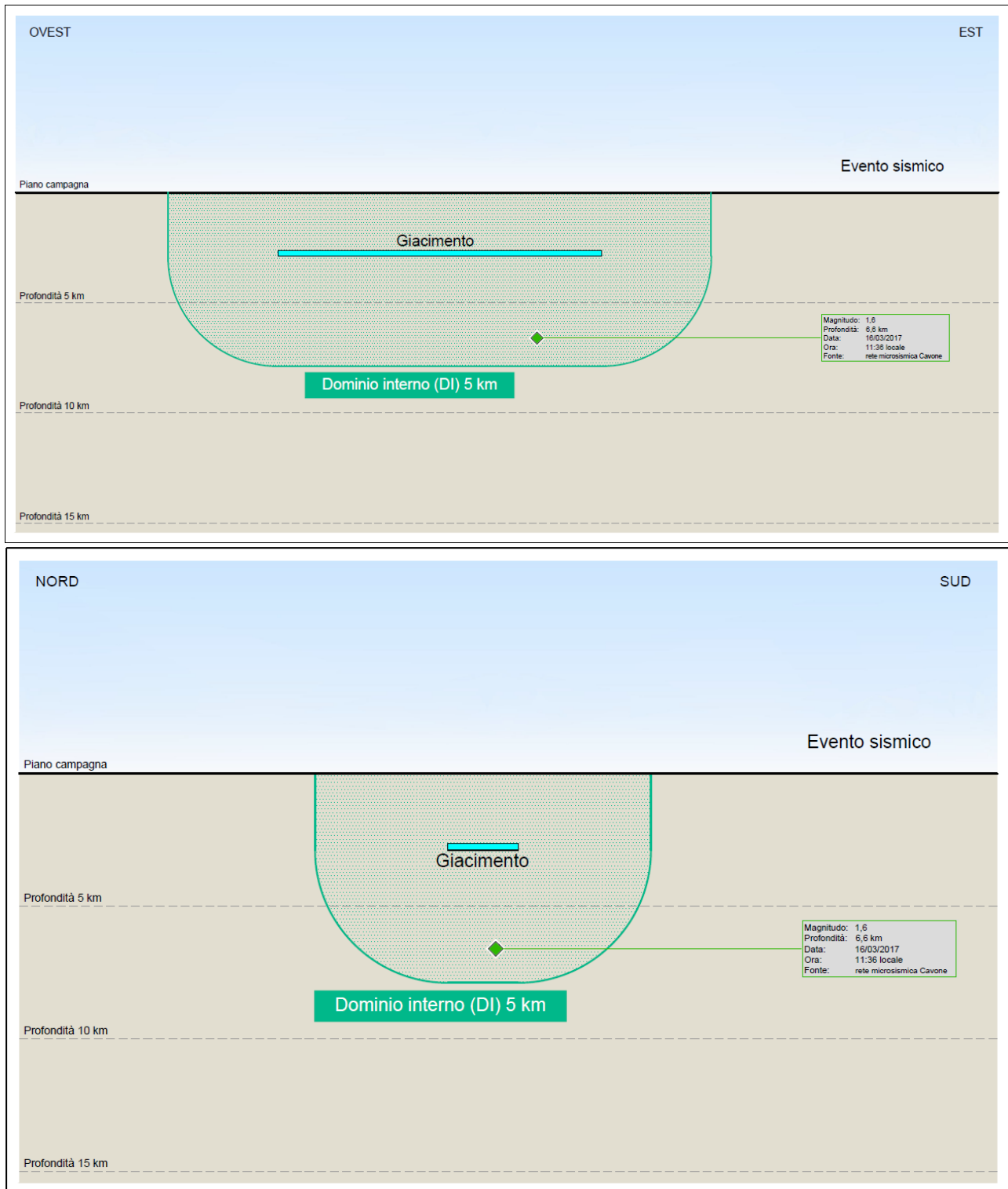
Figura 2 - Sezioni schematiche tracciate in direzione Ovest-Est (sopra) e Nord-Sud (sotto) riportante l'ubicazione dell'ipocentro dell'evento del 16 marzo 2017 rispetto al Dominio Interno di rilevazione.
